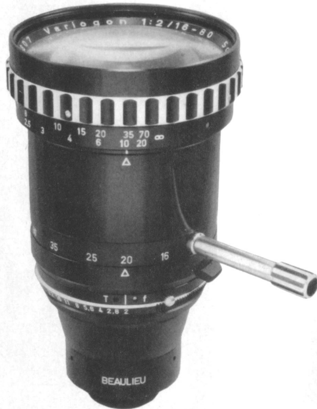
Variogon 1:2/16-80 mm Gewicht: 630 g Länge: 127 mm Größter Durchmesser: 72 mm Anzahl der Linsen: 16 Bildwinkel: 7,4°-44° Einstellbereich: 1,50-∞ Filtergröße: Einlegefilter S. 8/9 Völlig schließende Objektivblende
