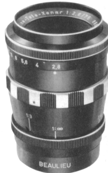
Makro-Tele-Xenar 1:2,8/75 mm Gewicht: 280 g Länge: 75 mm Größter Durchmesser: 50 mm Anzahl der Linsen: 5 Bildwinkel: 10° Einstellbereich: 1:∞-1:2 Filtergröße: Einlegefilter S. 6
