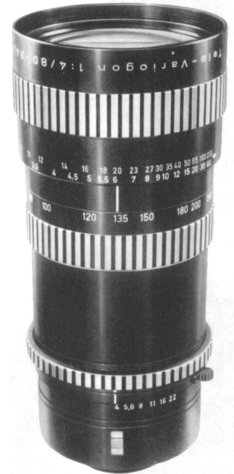
Tele-Variogon 1:4/80-240 mm Gewicht: 1750 g Länge: 220 mm Größter Durchmesser: 85 mm Anzahl der Linsen: 14 Bildwinkel: 9°-3° Einstellbereich: 1,80-∞ Filtergröße: Einlegefilter S. 9
